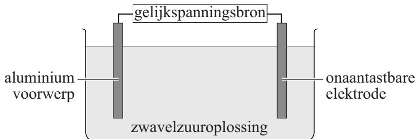
Het aluminium voorwerp is verbonden met een van de elektroden van een gelijkspanningsbron. De andere elektrode is een onaantastbare elektrode: het materiaal van deze elektrode neemt zelf geen deel aan de redoxreactie.
